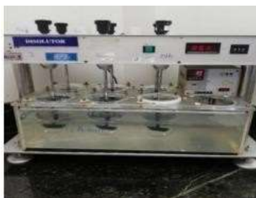
FIGURA 8 Ensayo de disolución (Erweka DT 6)
